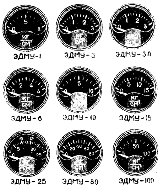
Фиг. 222. Варианты шкал приборов ЭДМУ с различными диапазонами измерения.
