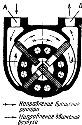
Фиг. 339. Вакуумнасос АК-4.
